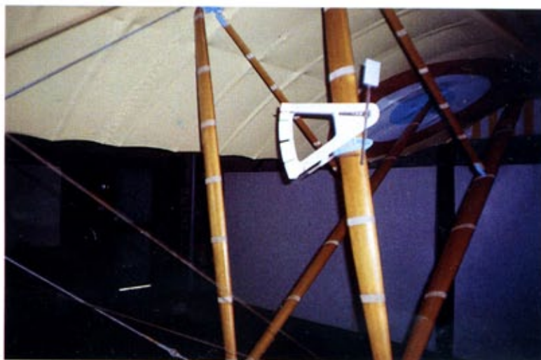
Un indicateur de vitesse Etévé installé sur un Caudron G3. Un instrument ULM avant la lettre qui est encore monté sur les Poux du Ciel Ballérit.
